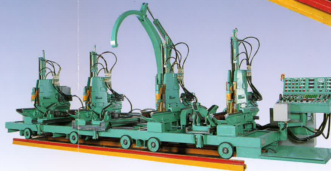
▲写真は車乗式HGT-900Sに注文装備品のノーマン走行装置、パターン歩出、S型車乗式キャッチャー等を装備したものです。
