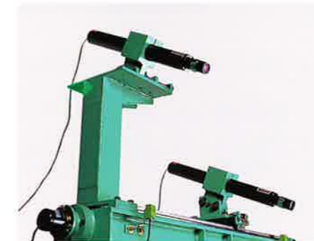
▲歩出連動式レーザーマーキング Laser marking synchronized with set-works
