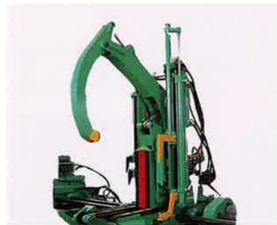
スパイダーハンドα型キャッチャー Spider Hand α Type Log Catcher.
