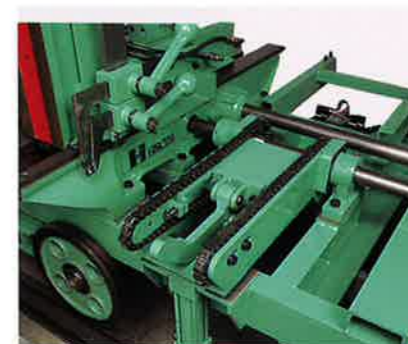
タックルターナー Log Overturning Device with Clamber.
