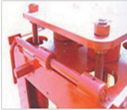
押さえローラーは、4箇所のサドルスプリングで強い圧力をつくり、一方向の原木の傾きを防ぎます。
